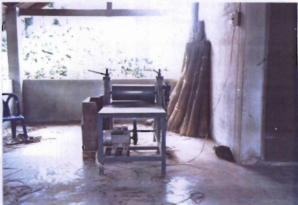
เครื่องรีดกระทงไฟฟ้า ประดิษฐ์กรรมจากชาวทะเลน้อย
