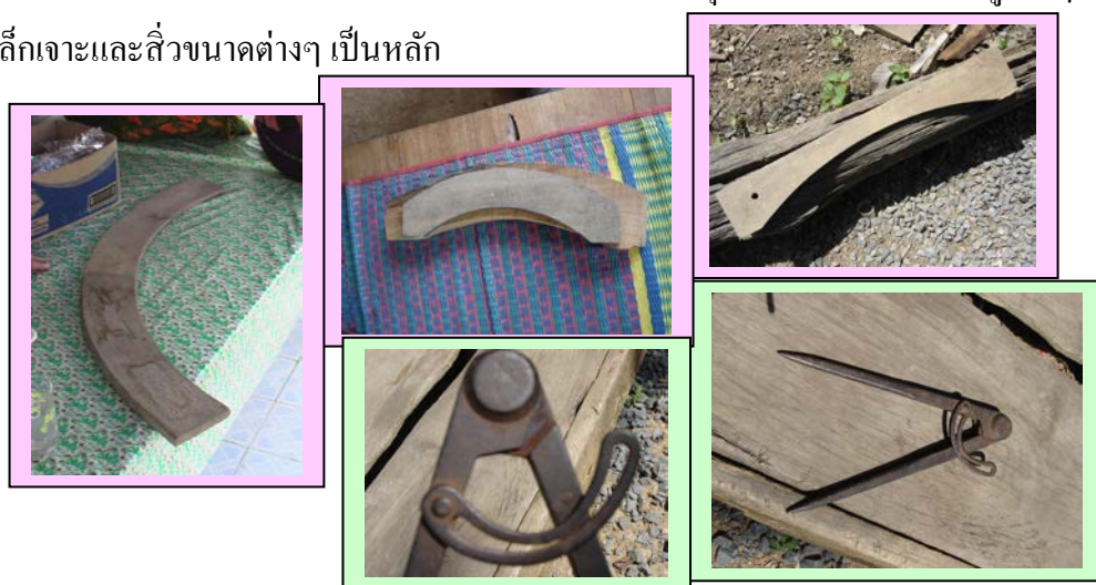
รูปที่ 25 ไม้แบบที่ใช้ในการทำฝักขาม และวงเวียนเหล็ก
