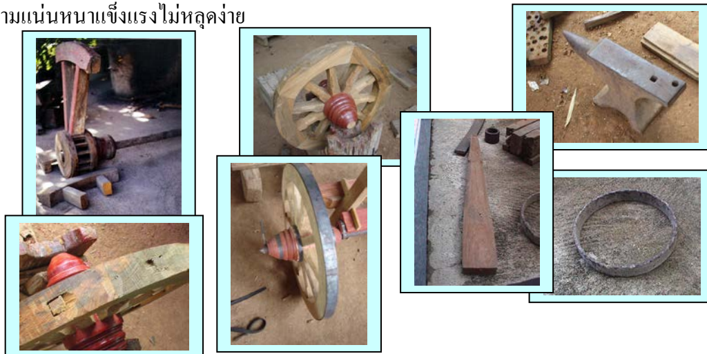
รูปที่ 28 การประกอบล้อเกวียน
