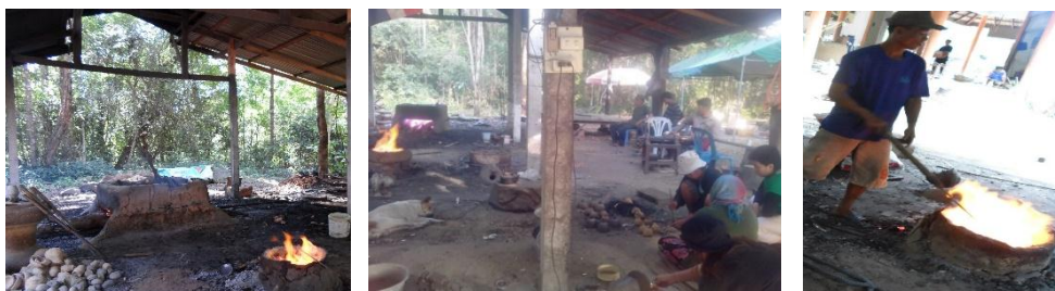
ภาพที่ ๔.๑๖ แสดงอุปกรณ์เตา และเบ้าหลอมสำหรับงานทองเหลือง
