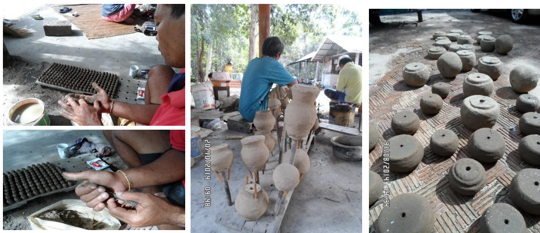
ภาพที่ ๔.๒ แสดงการขึ้นรูปและปั้นหุ่นให้ได้ตามผลิตที่ต้องการแล้วนำไปตากแดด
