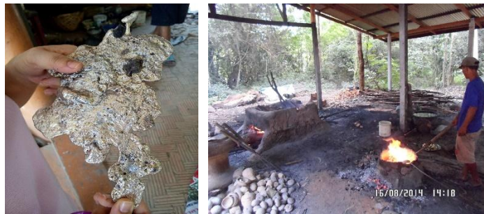
ภาพที่ ๔.๑๐ แสดงการนำเอาโลหะมาหลอมละลาย เพื่อเททอง
