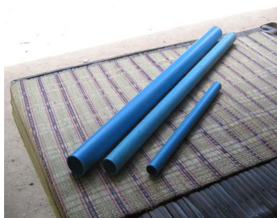
ภาพประกอบ 14-17 หางบั้งไฟทำด้วยท่อพีวีซีแทนไม้ไผ่
