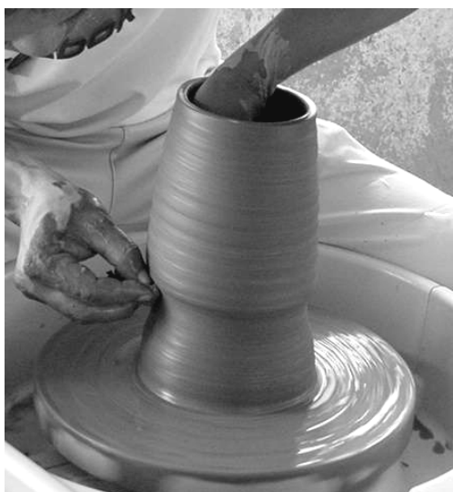
ภาพที่ 4 การดึงรีดดินให้ได้เป็นทรงกระบอก
