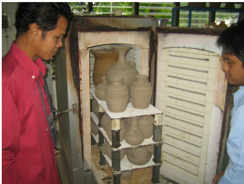
ภาพที่ 70 การเรียงผลิตภัณฑ์เข้าเตาเผาดิบ
