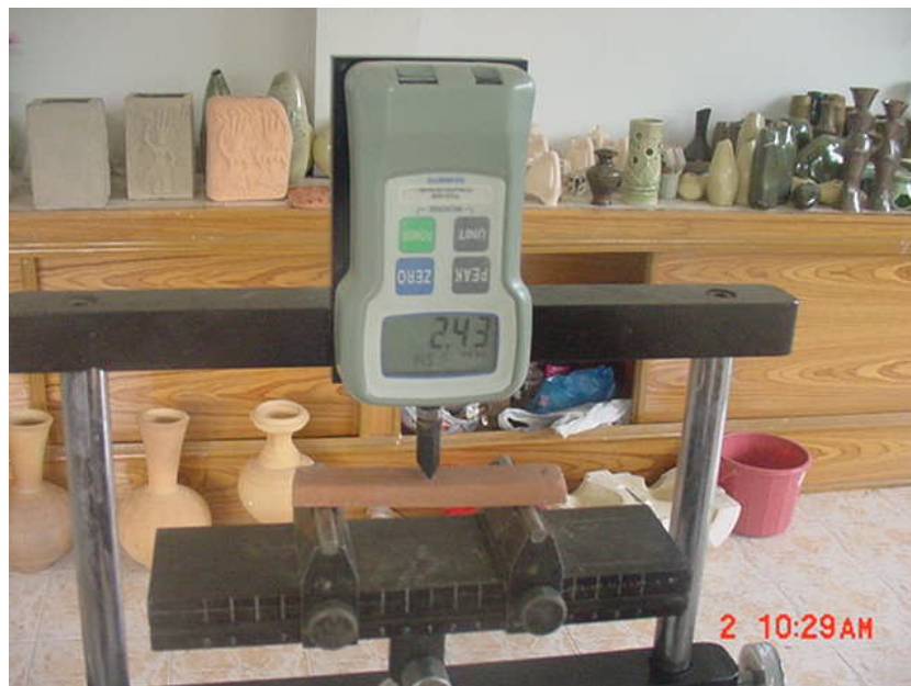
ภาพที่ 62 การทดสอบค่าความแข็งแรงของเนื้อดิน
