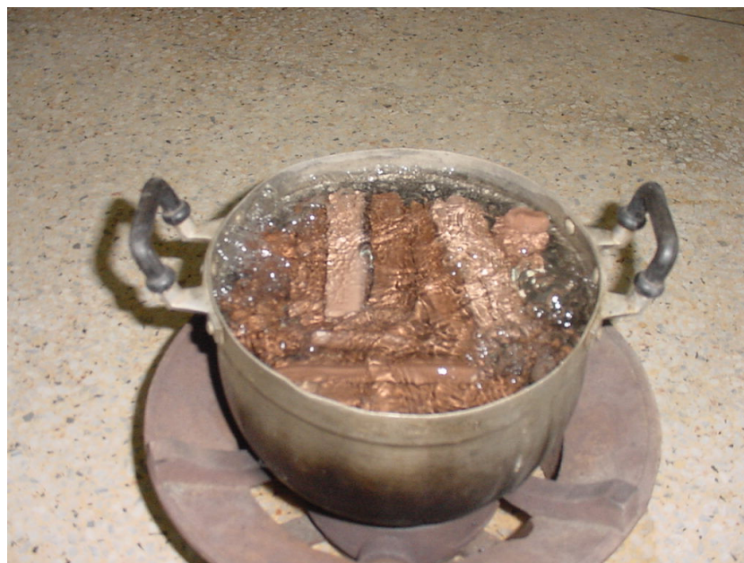
ภาพที่ 63 การดัมทดสอบการดูดซึมน้ำของเนื้อดิน
