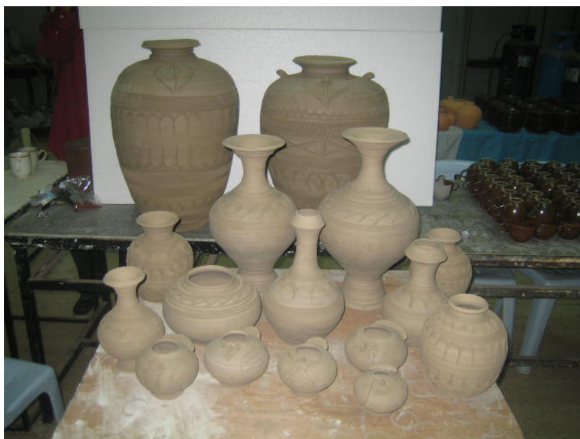
ภาพที่ 69 การฝังผลิตภัณฑ์ให้แห้งเตรียมเผาดิบ
