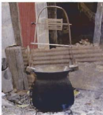
ภาพประกอบที่ ๔.๕๓ การติดตั้งเครื่องสาว ไหมบนหม้อหนึ่ง
