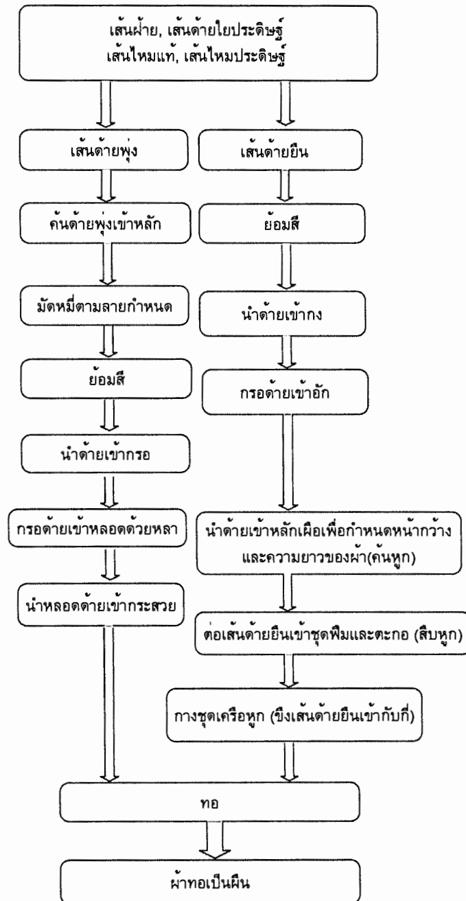
แผนภูมิประกอบที่ ๔.๗ กระบวนการทอผ้ามัดหมี่
