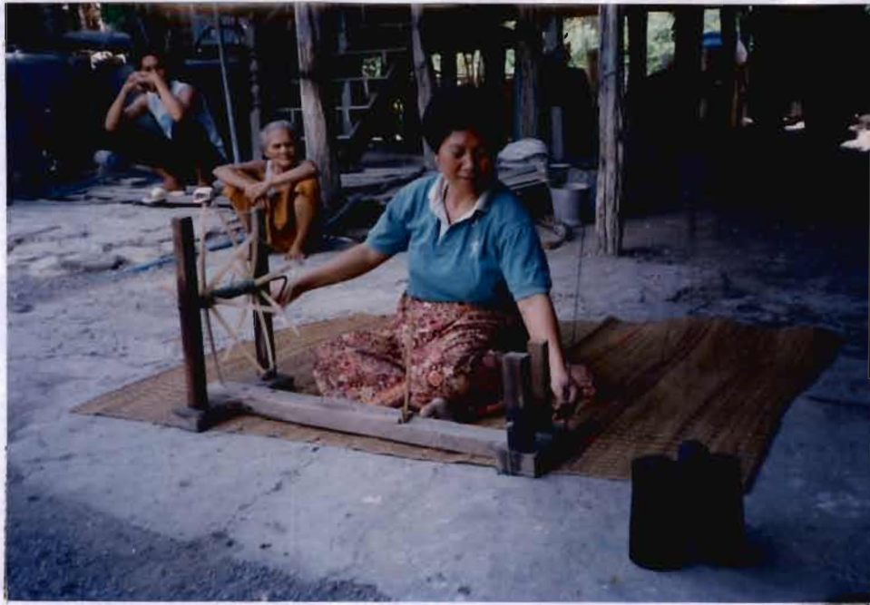
ภาพที่ 21 หลาปั่นหลอดแบบโบราณ ใช้มือหมุนวันหนึ่งทอได้ไม่กี่หลอด
