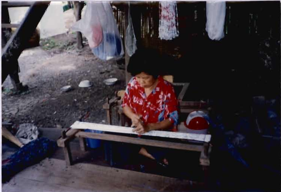
ภาพที่ 24 โองมัดหมี่แบบปัจจุบันเป็นแบบแนวระนาบมัดหมี่ได้ทีละหัว
