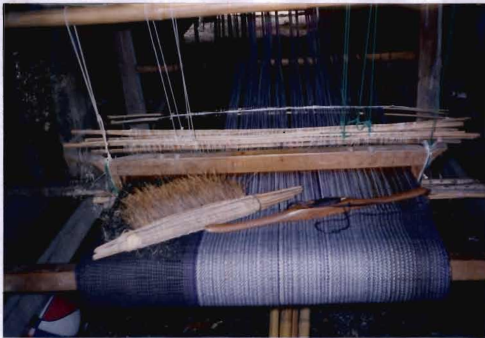
ภาพที่ 18 อุปกรณ์การทอกี่โบราณ หัวด้าย และกระสวย
