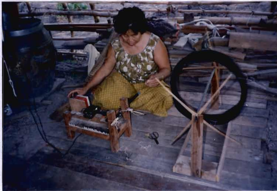
ภาพที่ 22 หลาปั่นหลอดแบบปัจจุบัน ใช้มอเตอร์เป็นเครื่องทุ่นแรงทำให้รวดเร็ว
