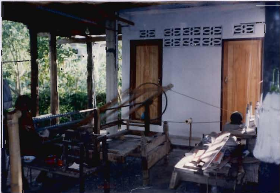
ภาพที่ 26 เครื่องคั้นไหมแบบปัจจุบัน ใช้มอเตอร์ให้รวดเร็ว สามารถกำหนดจำนวนรอบได้
