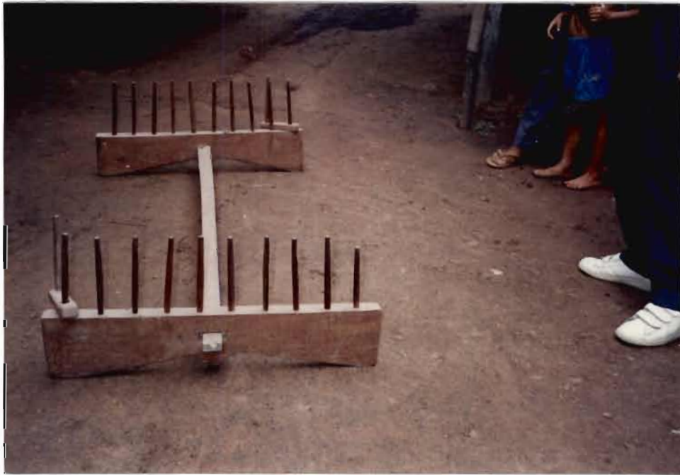
เชอทวง เป็นอุปกรณ์ใช้สืบผูก (เป็นการนำเส้นไหมมาจัดทำเป็นเส้นขึ้น)
