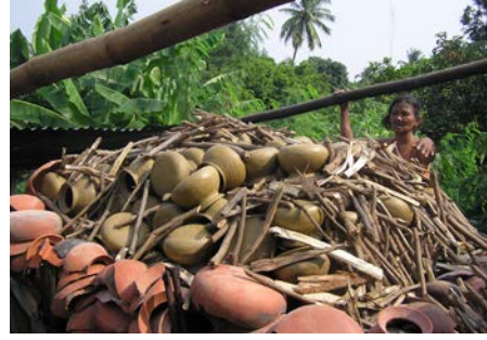
4. เรียงเต็มเตาเผาจนถึงจอมเตา (บนสุดของเตา)
