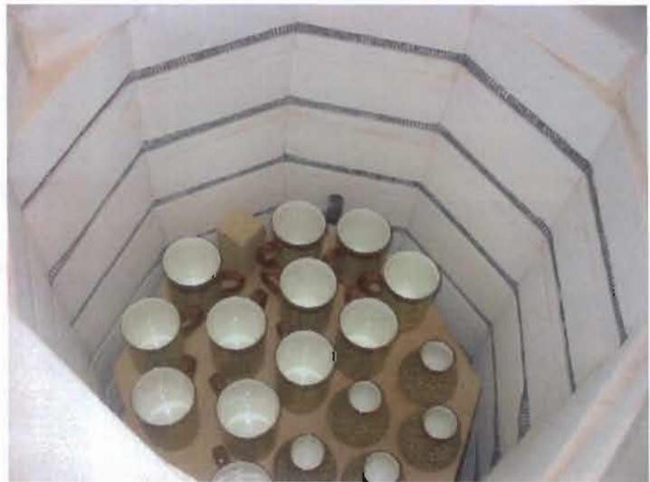
ภาพประกอบ การนำเอาเครื่องเบญจรงค์ที่เขียนลายเรียบร้อยแล้วลงเตาเผาเพื่ออบสี
