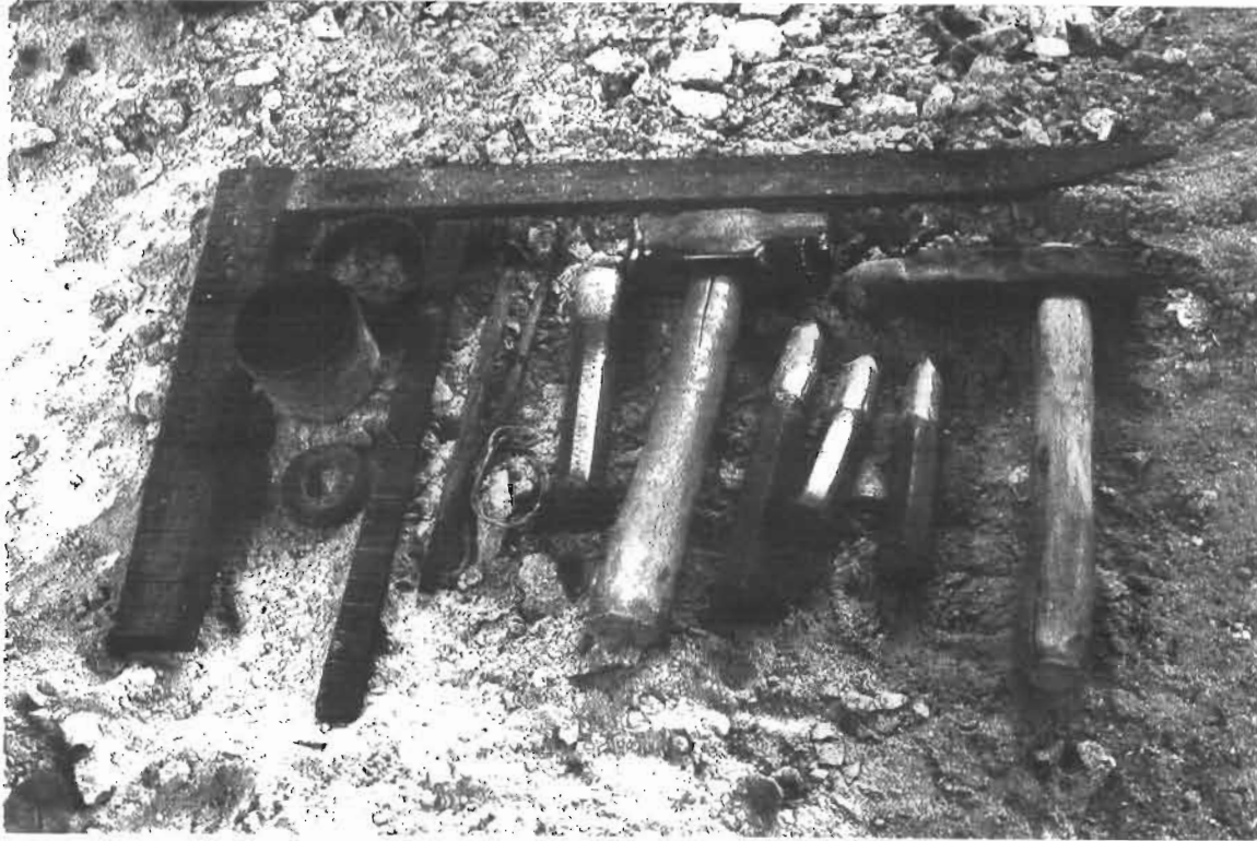
ภาพที่ 44 เครื่องมือ และ อุปกรณ์แกะสลักหินแบบดั้งเดิม ข้อมูลจาก ลุ้น แซ่เต้
