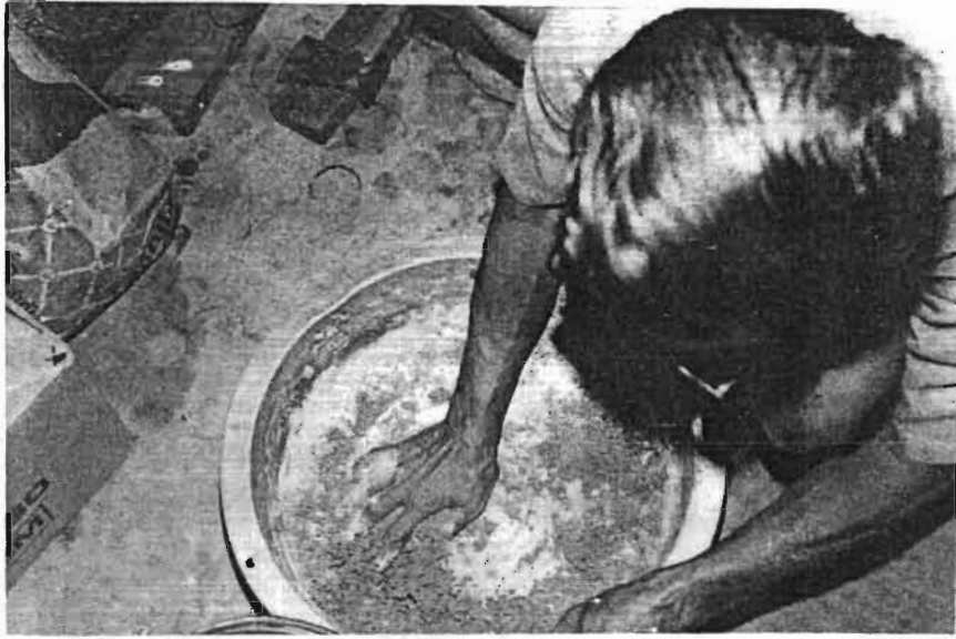
นำกระดาษที่โซลแล้วมาผสมกับปูนซีเมนต์ แล้วเทเหยียว และกวาด ลาเท็กซ์ นวดให้เข้ากันดี
