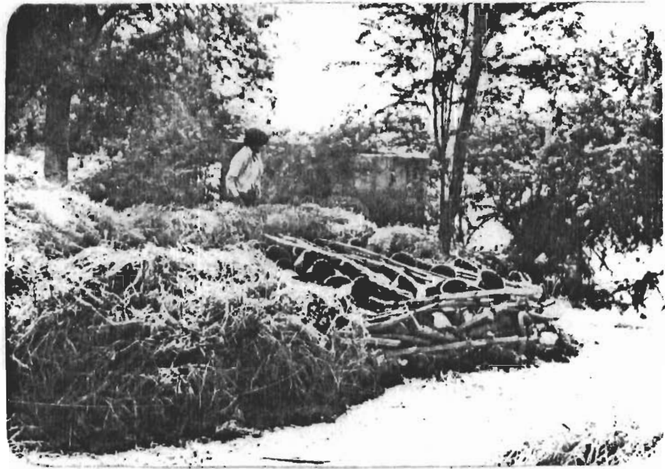
๓๘. สถานที่ที่จะเผา มีการเตรียมฟางข้าว ไม้ซอ และนำผลิตภัณฑ์ไปวางไว้เตรียมเผา
