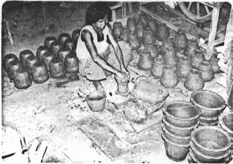
๒๑. การขึ้นรูปครั้งแรก ซึ่งจะมีลักษณะเป็นทรงกรวยแต่ภายในถ่วง มีขนาดเท่ากับ เครื่องปั้นที่จะเป็น
