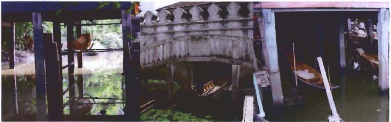
รูป 5-1 การจอดเรือพระที่พบเห็น จากซ้าย การจอดเรือยกไว้ทำให้เรือแห้งและเบา, การจอดในอู่จอด และการจอดที่ได้ถุนหอนั่น
