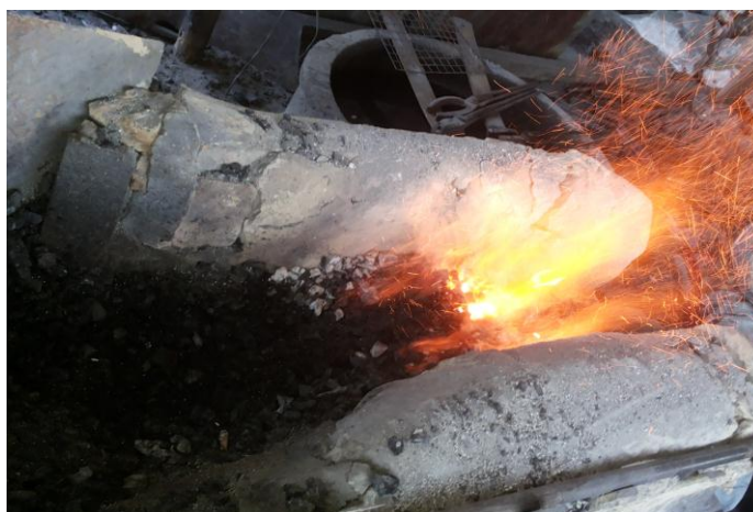
ภาพที่ ๔.๕ เตาสำหรับเผาเหล็กแบบดั้งเดิมซึ่งทำจากดินเหนียว
