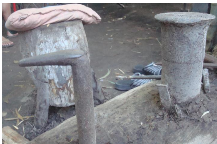
ภาพที่ ๔.๖ ทังตีเหล็กใช้ในการรองแรงตีด้วยค้อนในการขึ้นรูป
