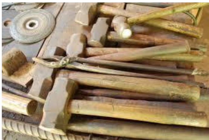
ภาพที่ ๔.๓ ค้อนตีเหล็กใช้ในการตีขึ้นรูป
