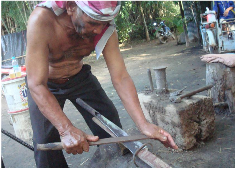
ภาพที่ ๔.๑๙ การรับคมมีดแบบดั้งเดิมโดยใช้ตะไบขัด
