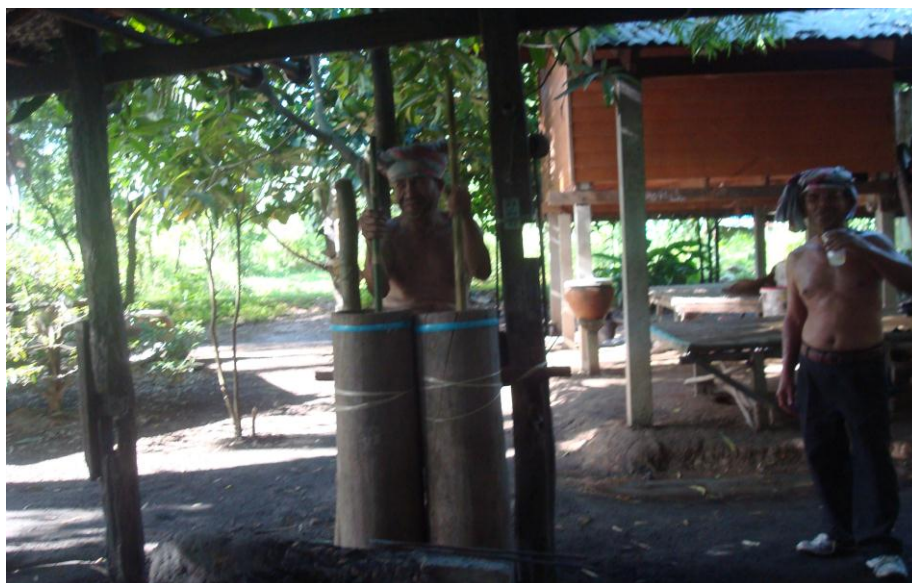
ภาพที่ ๔.๑๖ เครื่องมือการเป่าลมให้กับเตาเผาเหล็กแบบดั้งเดิมซึ่งในปัจจุบันไม่มีการใช้แล้ว
