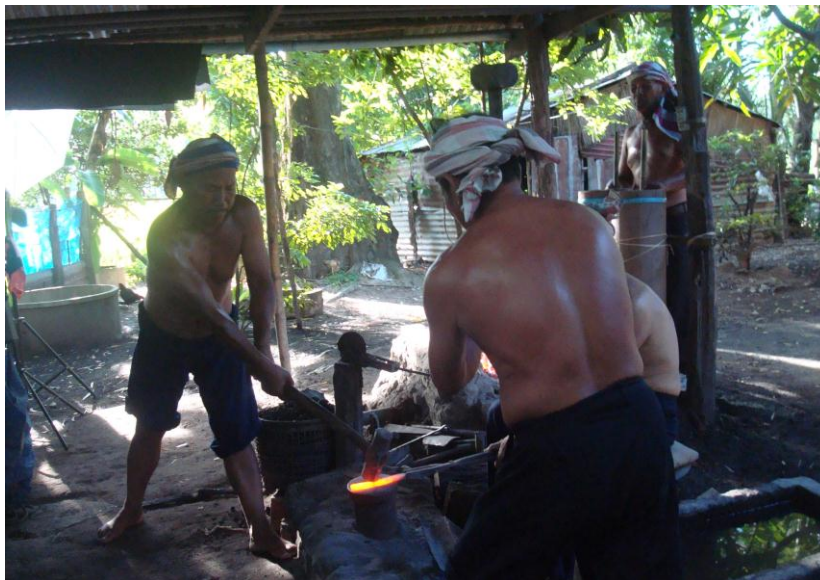
ภาพที่ ๔.๒๐ การตีมีดแบบดั้งเดิมอาจใช้แรงงานคน ๓ คน ซึ่งจังหวะการตีต้องสัมพันธ์กัน
